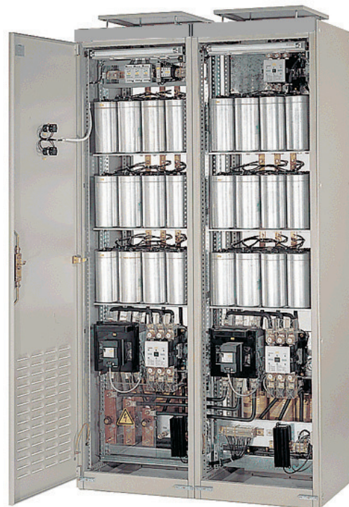
Filterkreis 2 x 175 kvar für 504 A Oberschwingungsstrom im Schrank 2275 x (2 x 600) x 625 mm Schutzart IP20, Vorderansicht
